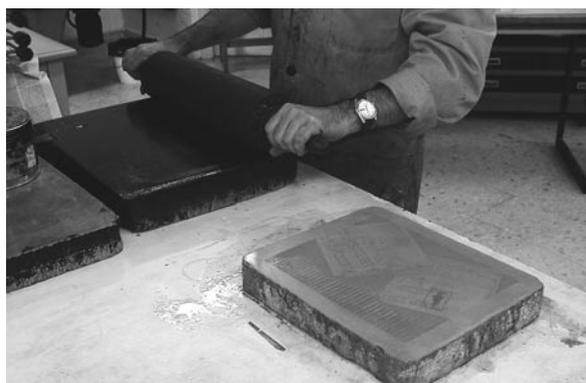
1.D.19.- Cargar el rodillo con tinta de levantar.
