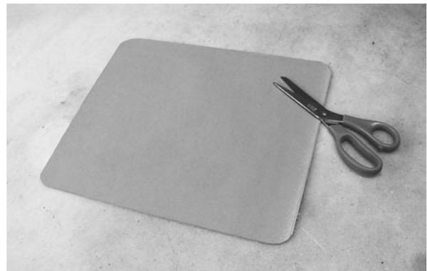
A.1.- Plancha de aluminio. Recortar las esquinas.
