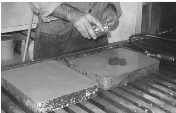
1.B.23.- Aplicación del carborundo de calibre fino.
