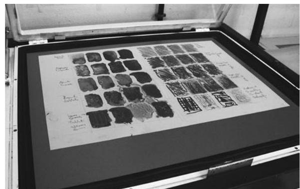
E.5.- Colocada la plancha sobre la prensa de vacío, situar la transparencia con la cara de dibujo sobre la emulsión de la plancha presensibilizada.
